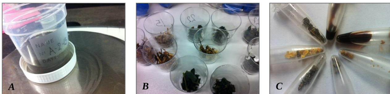
Billede 2: A) 120 ml plasticbæger m. jord og gødning; B) de friske gødninger afvejet til inkubation, C) de tørre og flydende gødninger afvejet til inkubation.
