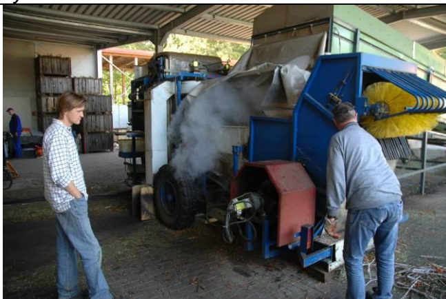
Bærrene rystes af grenene i et specielt "tærskværk"
