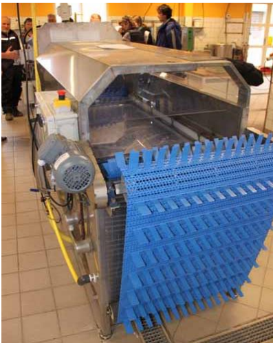
Varmebehandling af frugten inden lagring giver øget holdbarhed og færre problemer med lagersygdomme. Teknikken er dog endnu ikke implementeret helt i praksis. Billedet er af en prototype til varmebehandling af frugt på Aarhus universitet, Food, Årsløv.
