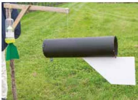
Fælde til marmoreret bredtæge. Der er fanget op til 50 tæger på et døgn i Sydholland. Den sorte fælde er udviklet i New Zealand. Den består af et sort rør, der vender sig med vinden, og er udstyret med en fælde og et lokkemiddel.
