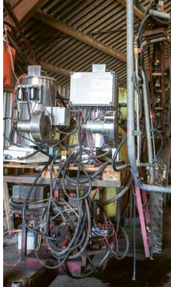
En ombygget sprøjte forsynet med oliemotorer anvendes til varmtvandsbehandling af ukrudtet i rækkerne med buskfrugt.
